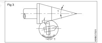
$\frac{C}{2}$  Ratio of inclination - 1:2 x
